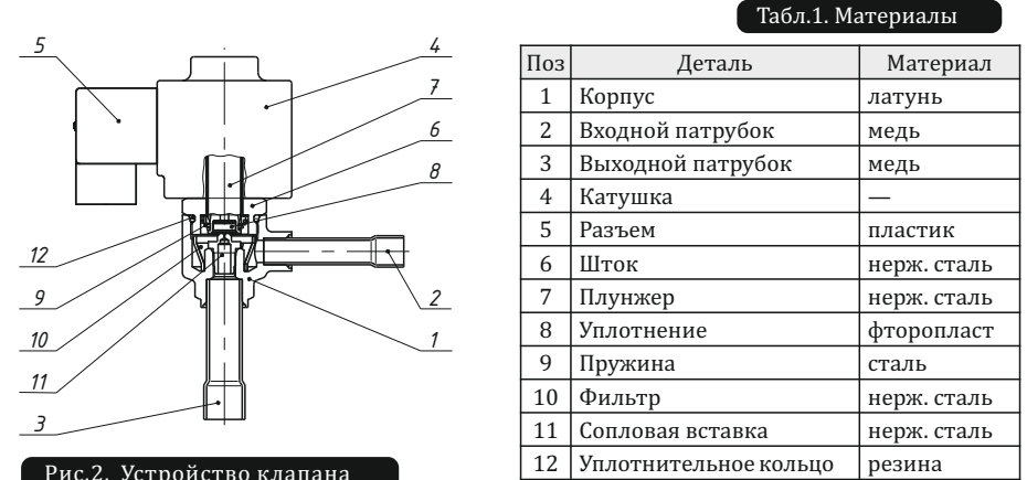
Рис.2. Устройство клапана
